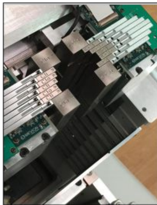
图 3-8 自适应准直器示意图
